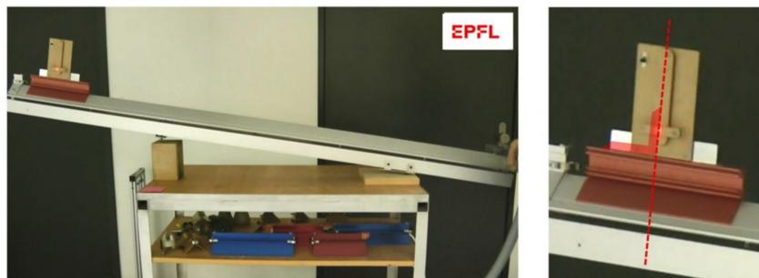
Nous avons observé en cours qu'un pendule fixé sur un chariot reste perpendiculaire au plan incliné lorsque le chariot descend le long du rail sous l'effet de la pesanteur (chute libre, pas de frottement). Nous allons dans cet exercice le démontrer.
